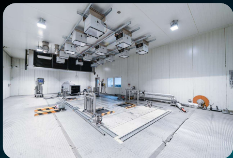
整车排放试验室
